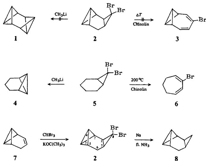
Durch Addition von Dibromcarben an Tricyclo[4.1.0.0<sup>2,7</sup>]hept-3-en (**7**), das aus Benzvalen in präparativ nützlichen Mengen zugänglich ist<sup>4</sup>), entsteht **2** mit 68% Ausbeute. Seine Umsetzung mit Natrium in flüssigem Ammoniak liefert mit 52% Ausbeute den Stammkohlenwasserstoff **8**.
