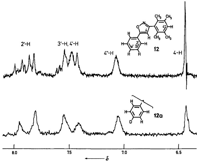
Abb. 1. Aromatenbereich des <sup>1</sup>H-NMR-Spektrums von 3-Duryl-5-phenylisoxazol (12, oben) und 3-Duryl-5-[4-D]phenylisoxazol (12a, unten, schlechtere Feldhomogenität) bei 60 MHz in CDCl<sub>3</sub> mit TMS als internem Standard
