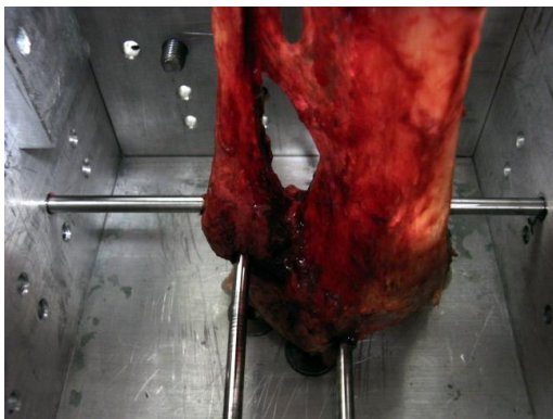
Abb. 4-22: proximale Unterschenkelfixierung durch drei Steinmannnägeln
