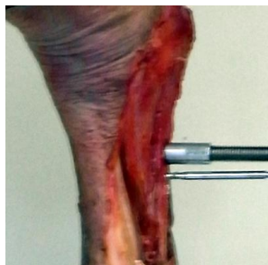
Abb. 4-32: Versuchsaufbau ES IV, Ausschnitt Positionierung des Stempels und der Schraube, Probe 19
