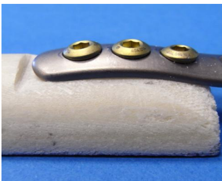
Abb. 6-6: distaler Ausschnitt der nicht winkelstabilen Konturenplatte im osteoporotischen Kunstknochen
