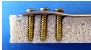
Abb. 4-38: distaler Ausschnitt mit drei Spongiosaschrauben im osteoporotischen Kunstknochen, Ansicht von lateral
