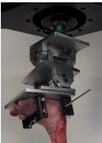
Abb. 4-25: Kreuzgelenk mit Fuß in der Materialprüfmaschine, Probe 20
