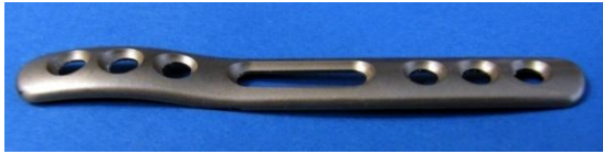
Abb. 4-36: nicht winkelstabile 6-Loch Konturenplatte (Titan-Aluminium-Vanadium Legierung (Ti6Al4V,ISO5832/3)), Ansicht von lateral
