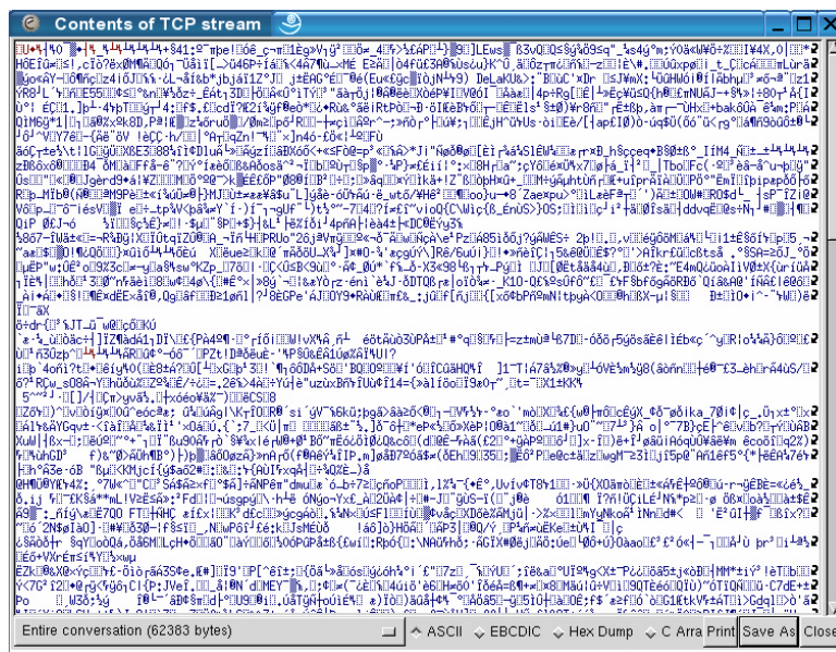
Abbildung 2: Falls der Zugriff auf eine WWW-Seite per https erfolgt, ist der Inhalt der abgehörten Pakete nicht lesbar und nach aktuellem Stand der Technik auch nicht entschlüsselbar.
