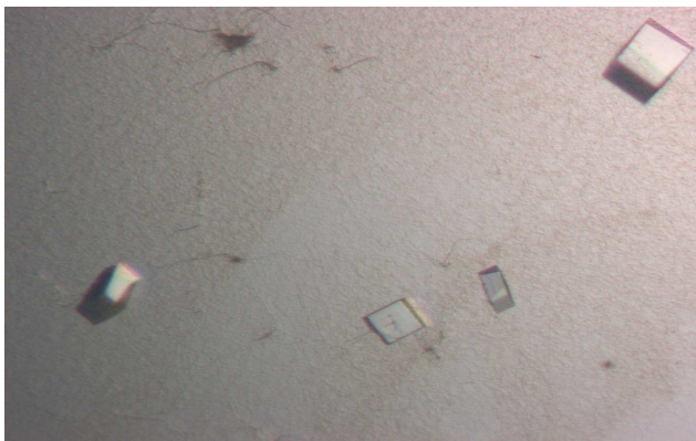
Abb. 3.22: SARS-CoV-M pro - TS174 -Co-Kristalle. Bedingung: 0,1 M MES-Puffer (pH 6,0); 6-8% PEG 6000; 5% DMSO; 1 mM DTT. Proteinkonzentration: 8 mg/mL; Temperatur: 18 °C; Wachstumszeit: 2-5 Tage.
