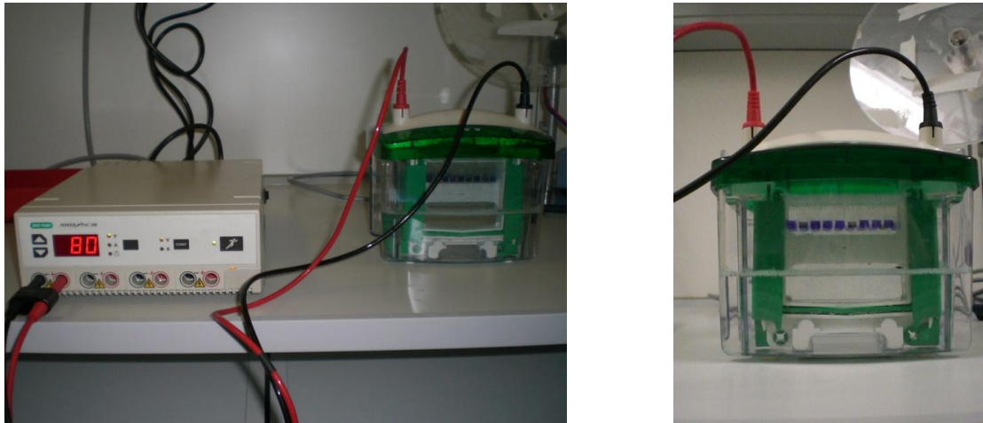
Abbildung 7: Diskontinuierliche SDS-Polyacrylamid-Gelelektrophorese (SDS-PAGE). Der Lauf erfolgte zuerst 45 min bei 80 V bis die Proben vom Sammelgel ins Trenngel übergegangen sind, danach zur vollständigen Trennung für 80 min bei 120V.
