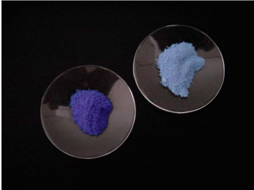
Abb. 5.3: Silicat-Nanopartikel mit TFPTMSi-Gehalt = 0.3 % (w/w), JA133-Si = 6.68  $\mu\text{mol/g SiO}_2$ ,  $\varnothing \approx 43$  nm (links); Silicat-Nanopartikel mit TFPTMSi-Gehalt = 0.2 % (w/w), JA133-Si = 6.53  $\mu\text{mol/g SiO}_2$ ,  $\varnothing \approx 72$  nm (rechts).
