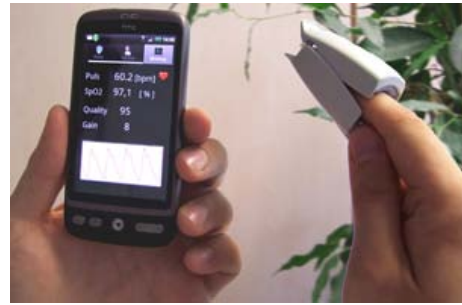
Das Prinzip der Telemedizin: Medizinische Daten werden erfasst – hier Sauerstoffgehalt und Pulsfrequenz über einen Fingerclip. Im Handy erfolgt die Weiterverarbeitung der Daten, bevor sie an eine medizinische Tele-Service-Zentrale übertragen werden. Bild: Zentrum für Telematik, Gerbrunn
