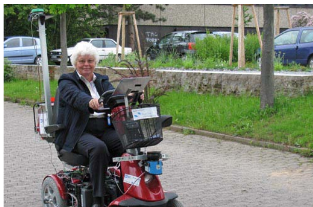
Mit Hilfe seiner Sensoren kann der Scooter seine Nutzer sicher zum eingegebenen Ziel fahren und sie dabei zuverlässig vor Hindernissen warnen. Foto: Uni Würzburg/Informatik VII
