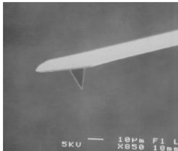
Abbildung 19: Rasterelektronenmikroskopische Detailaufnahme einer Silicium-Cantileverspitze
