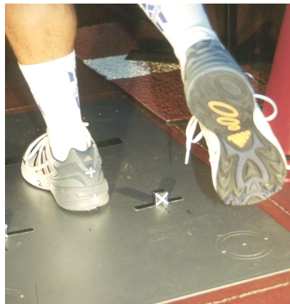
Abbildung 2: Kistler-Kraftmeßplatte zur Messung der Bodenreaktionskräfte
