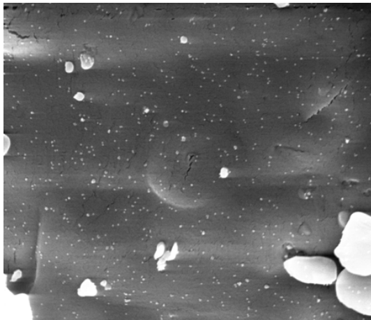
Beschleunigungsspannung 10 kV, Arbeitsabstand 6 mm, Vergrößerung 10000 x, Präparat Igepal1500, 2 μm Abb. 5.94: REM, GranuLac ® 200 mit 0,5 % Silica (ternäre ME, 30 nm), Mischdauer 30 min, Vergrößerung 10.000fach
