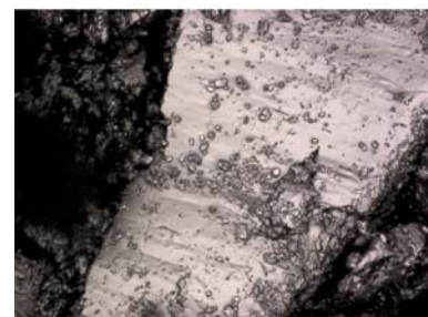
Abb. 5.10: CLSM-Aufnahme von GranuLac 60 min, Vergrößerung 150fach
