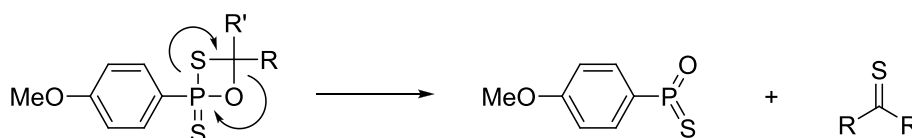
Schema 3-6: Umlagerung und Bildung einer stabilen P=O-Bindung (R, R' = Alkyl, Aryl).
