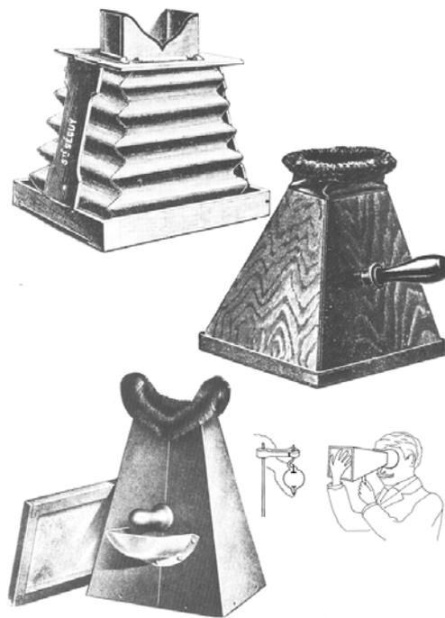
Abb.12: oben: de Seguy (1897), Fluoroskop genannt „Lorgnette humaine“; Mitte: Modell von Heller (1907); unten links: Kny-Scheerer (New York 1915), Fluoroskop mit Schutzvorrichtung für die Hand; unten rechts: Gebrauchsschema (133a)
