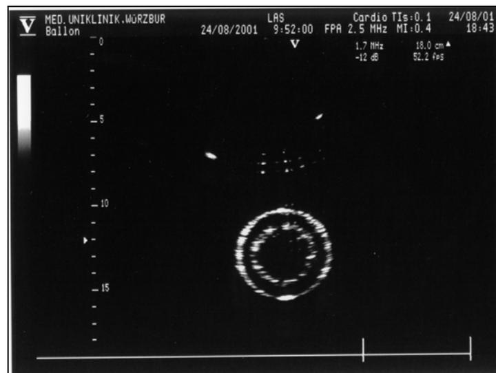
**Abbildung 12:** Ein kleinerer Gummiballon wurde in einen größeren gestülpt. Deutliche Darstellung der Grenzflächen; symmetrische Form der Innen- und Außenwand. Zwischen den beiden Ballons befinden sich 6 ml Aqua dest.
