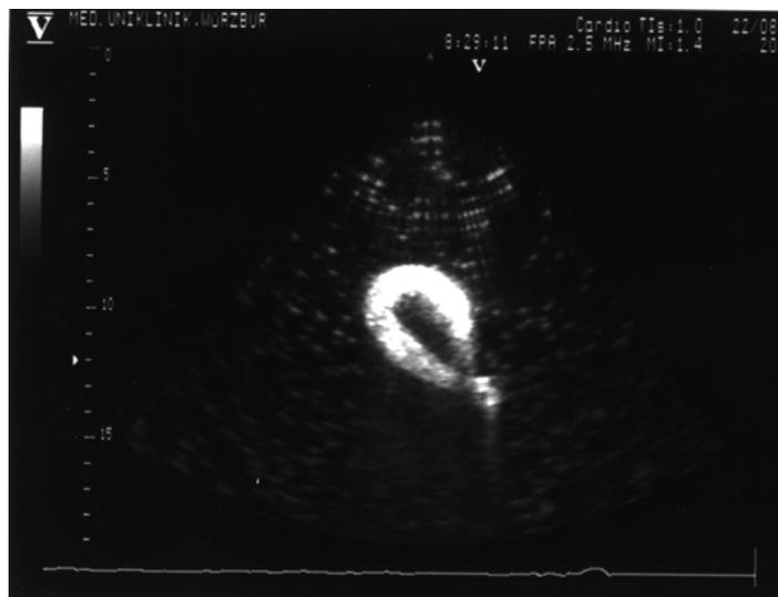
**Abbildung 14:** Metzeler Schaum GmbH, MA 3835 R: homogenes Binnenecho und gleichmäßige Wandstärke im Ultraschallbild bei gutem Kontrast zur Umgebung.
