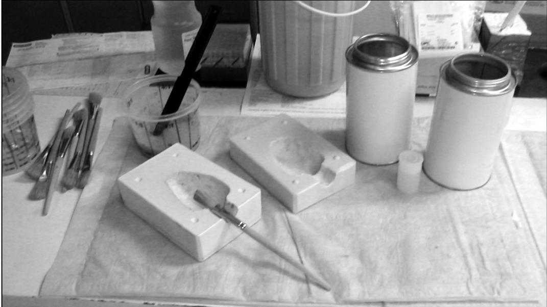
**Abbildung 8:** Utensilien zur Verarbeitung des Silikons: Pinsel, Messbecher, Negativform, Zwei-Komponenten-Silikon (große Behälter), Härtersubstanz (kleiner Behälter)
