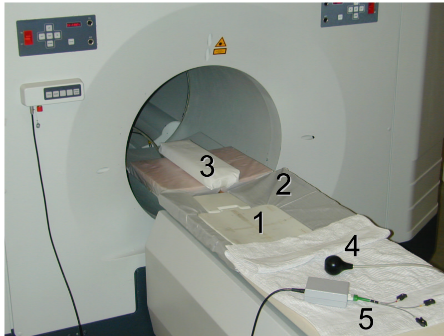
Abb 7.1: Der in den NMR-Experimenten am menschlichen Herzen verwendete Bruker 2,0 T Ganzkörpertomograph mit den beiden Oberflächenspulen und der EKG-Ableitung. 1: Siemens ^{31}\text{P}/^1\text{H} Oberflächen-Herzspule; 2: asymmetrische Polsterung (8 cm nach links verschoben). 3: Kopfablage aus Schaumstoff. 4: Patientenalarm-Druckball. 5: EKG-Ableitung mit Signalwandler.
