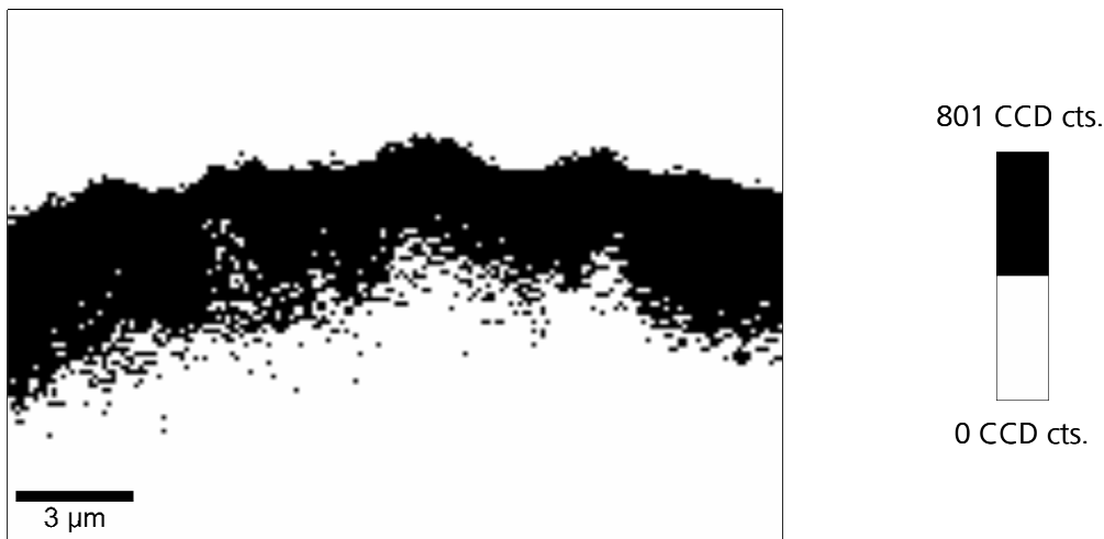
Abb. 4.5: \mu -Raman-Tiefenscan an der ORMOCER® Iva-Schicht einer LWS1-Kapsel und Legende (rechts). Die Schicht wurde dargestellt über die Intensität der \nu(\text{C-H}) -Schwingungen, ermittelt mittels eines Summenfilters von 2700 bis 3200 \text{cm}^{-1} . Der Schwellenwert weiß-schwarz liegt mittig zwischen den Randwerten, die auf null und das lokal ermittelte Maximum gesetzt sind, um eine Vergleichbarkeit zwischen verschiedenen Scans zu erreichen (vgl. Kap. 4.2.4).
