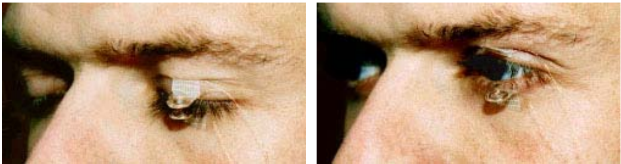
Abbildung 7-4: Proband mit Magnetspulen zur Erfassung des Lidschlusses und des Blickverhaltens. Eine der beiden Spulen ist am Oberlid, die andere am Unterlid befestigt.
