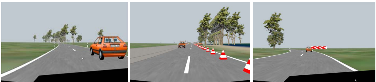
Abbildung 9-1: Beispielhafte Verkehrssituationen des Landstraßen-Parcours des Fahrsimulators des Würzburger Instituts für Verkehrswissenschaften (WIVW GmbH). Links: Überholen, Mitte: Baustelle mit Spurverengung, Rechts: Scharfe Linkskurve.
