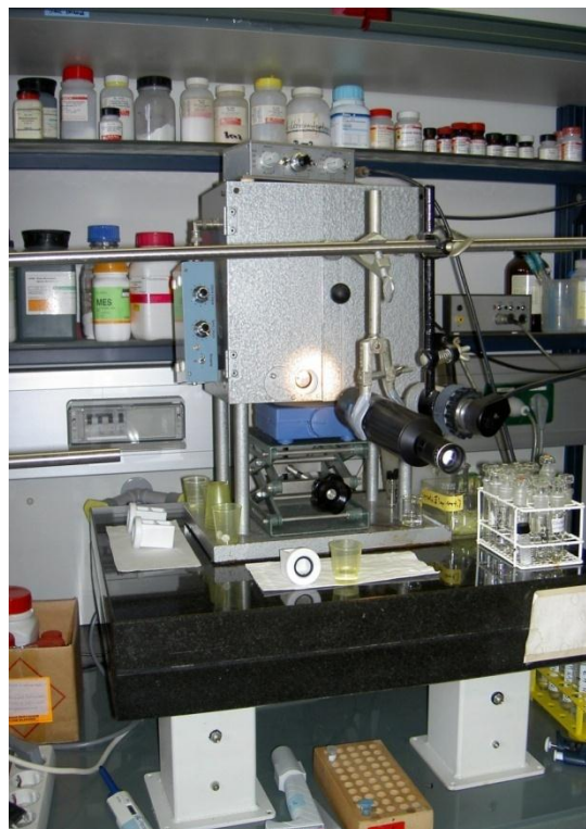
Abbildung 31: Aufbau der Black Lipid Bilayer Apparatur am Lehrstuhl für Biotechnologie der Universität Würzburg (Lehrstuhl für Biotechnologie, AG Benz, Universität Würzburg).
