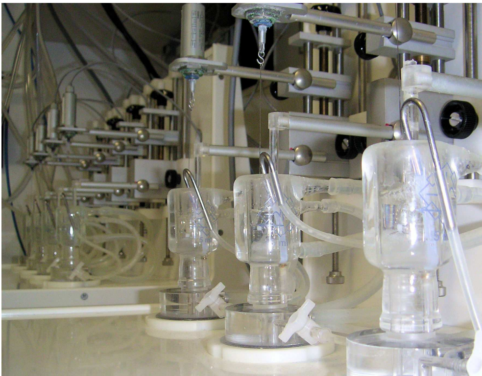
Abbildung 4: Organbad mit parallelen Einzelkammern. Abgebildet sind zudem die zentrale Pufferversorgung und die Begasung der Organkammern.
