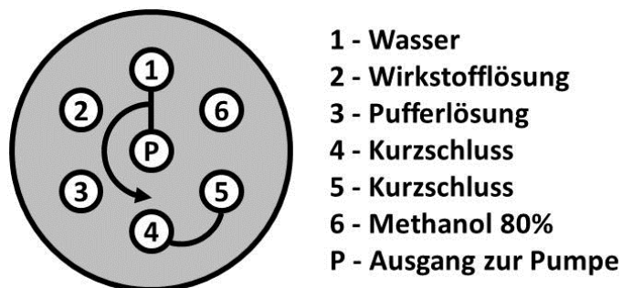
Abb. 14: Belegung der Positionen des 6-Wege-Ventils
