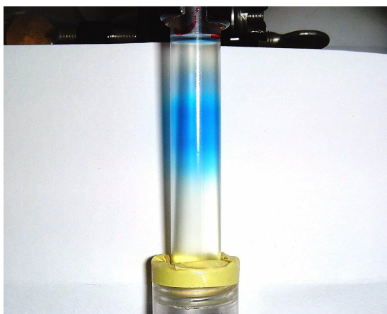
Abb. 4-34: C. paradoxa Cyanellen S100-Extrakt nach Ultrazentrifugation im Glyceringradienten (10–30 %)
