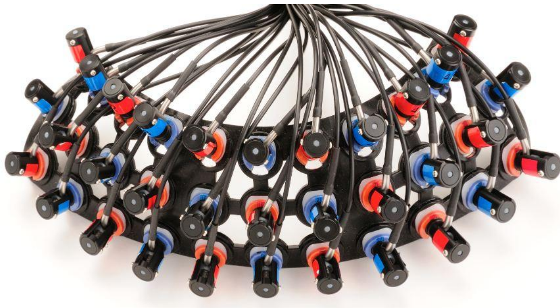
Abbildung 6: Probeset mit Emittlern (rot) und Detektoren (blau) von Hitachi Medical Co. (Japan)
