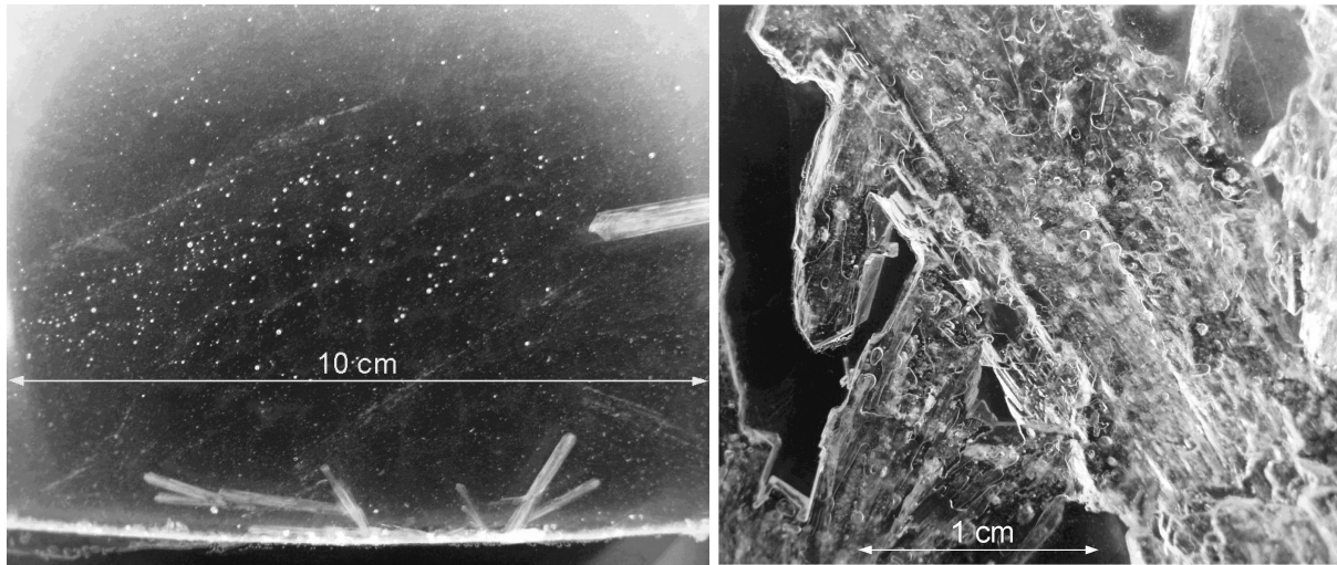
Abbildung 5.13: Beginn des Erstarrensprozesses beim L30 (links) und Ausschnittsvergrößerung nach Abschluss der Erstarrung (rechts) bei einer Schichtdicke von 1,6 mm.
