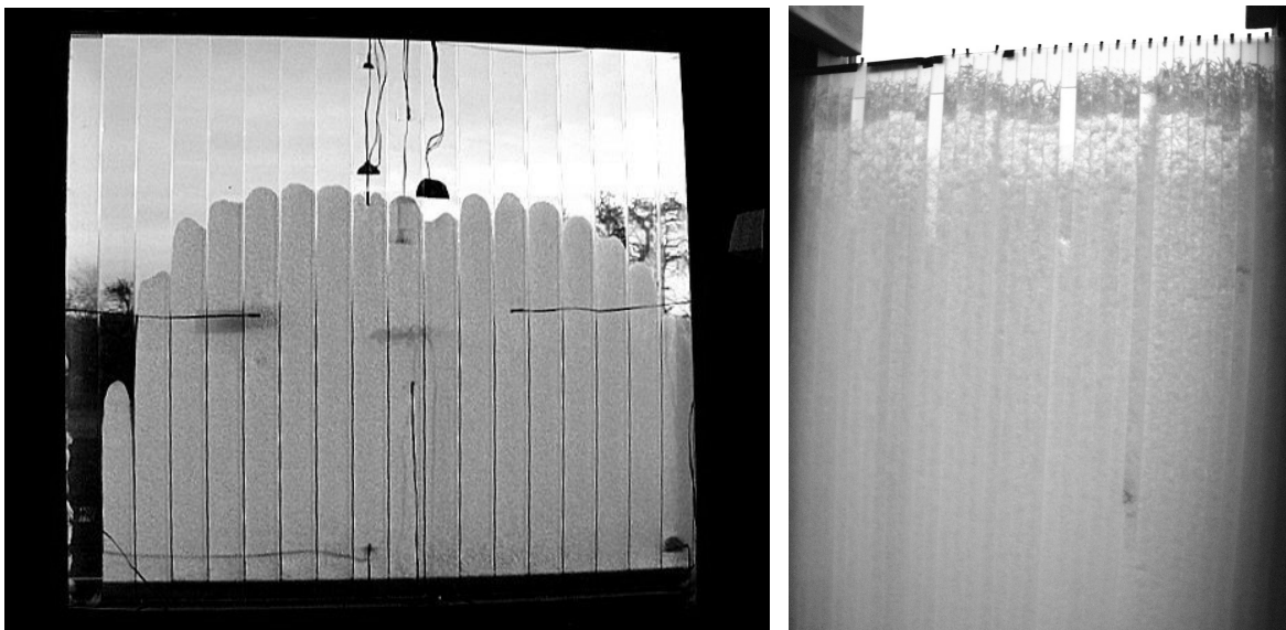
Abbildung 6.1: Innenansicht der Tageslichtelemente mit PCM bei Verwendung von RT25 im halbgeschmolzenen Zustand (links) und S27 im festen Zustand (rechts).
