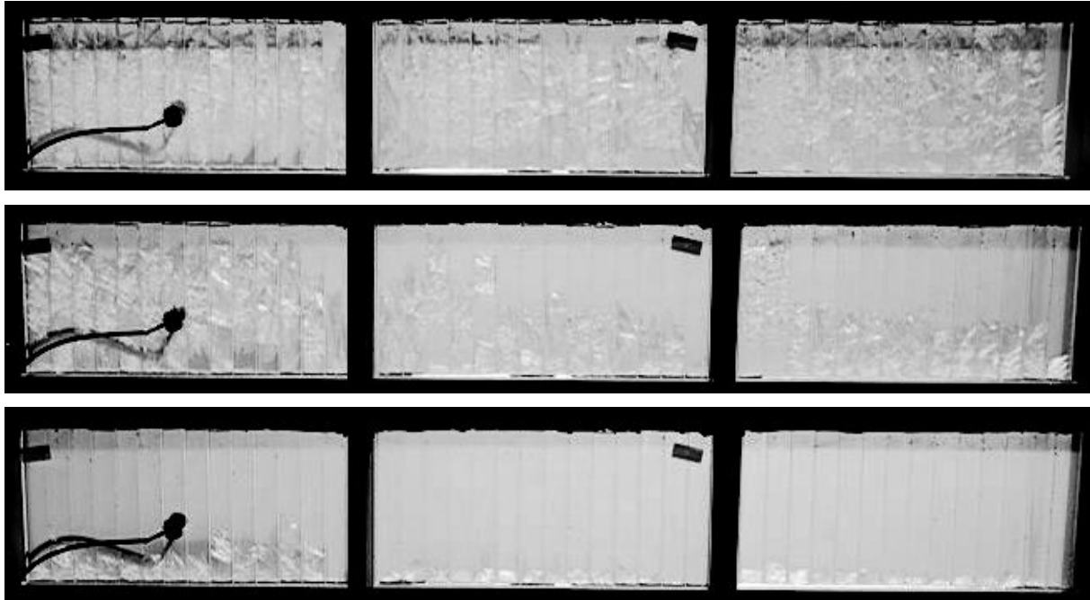
Abbildung 6.2: Aufschmelzprozess beim S27. Auch wenn das S27 schon stark aufgeschmolzen ist, bleibt das Festkörpergerüst bestehen (oberes Bild). Erst wenn die Kristallnadeln so weit abgeschmolzen sind, dass sie das Eigengewicht nicht mehr tragen können, beginnt das Festkörpergerüst zusammenzusacken (Mitte). Innerhalb kurzer Zeit sinkt das feste Material zu Boden und schmilzt dort auf (unteres Bild). Die Bilder entstanden im Abstand von jeweils 40 Minuten.
