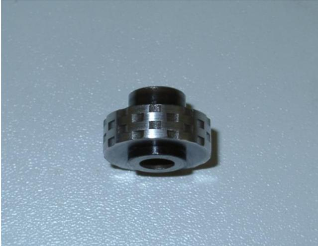
Abb.5 Antagonistenrad aus gehärtetem Stahl
