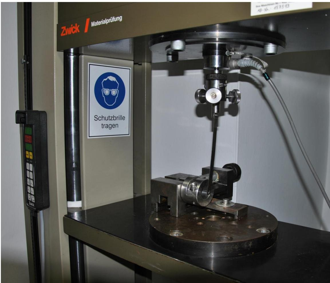
Abb.7a Versuchsaufbau der Abschermethode in der Universalprüfmaschine von Zwick
