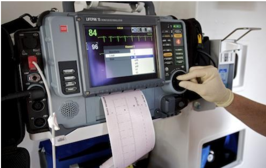
Abbildung 7: Ausdruck und telemetrische Übermittlung eines 12-Kanal-EKG im Rettungswagen mittels Lifepak 15 [25].
