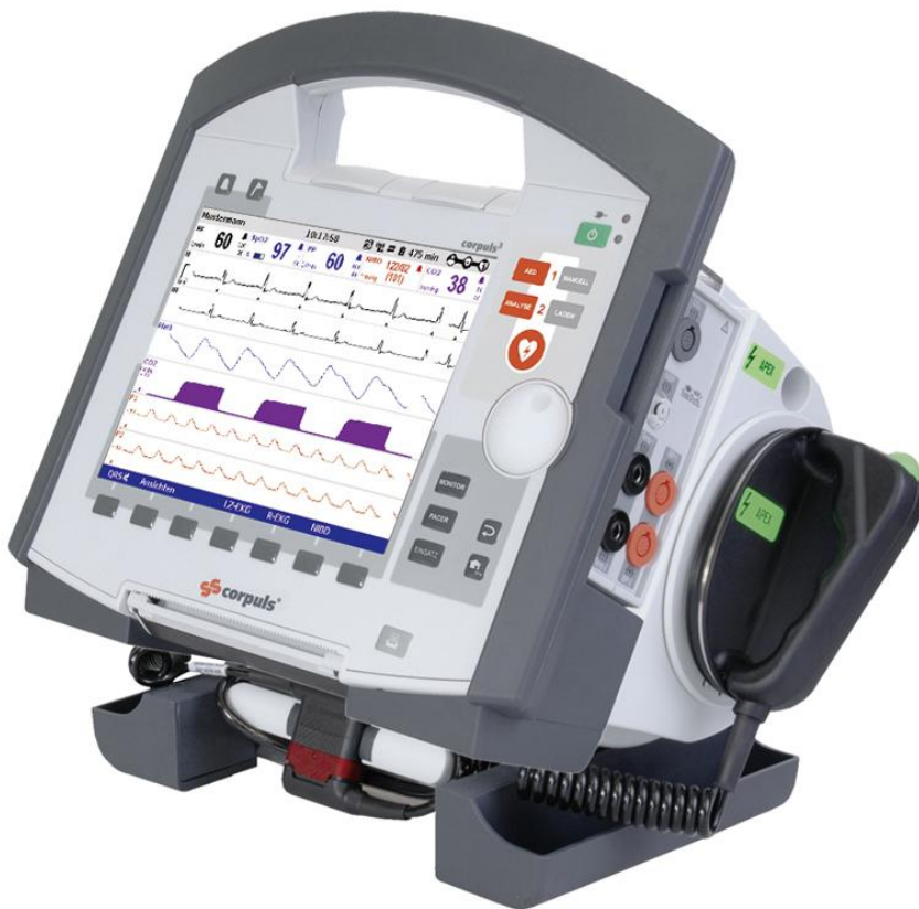
Abbildung 9: 12-Kanal-EKG und telemetriefähiger Corpuls 3 der Firma GS [27].
