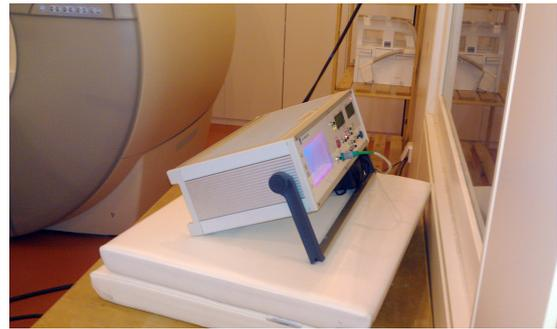
(b) Trigger-Unit zur Überwachung der Vitalfunktionen
