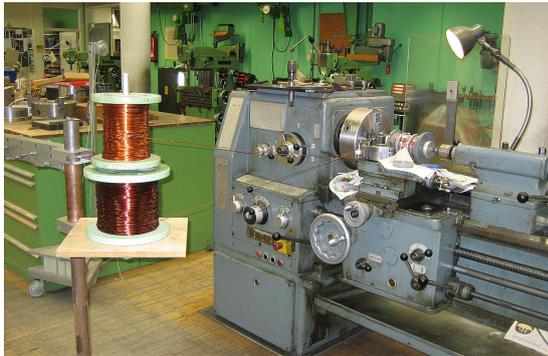
(c) Spule auf Drehbank zum Wickeln der Doppelwindung
