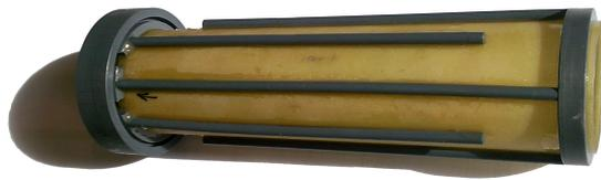
(a) innerer Spulenkörper mit Labyrinth
