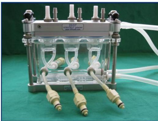
**Abb. 2.6 a:** Vitrocell®-Kammer (Vitrocell® Systems, Waldkirch), bestehend aus Metalldeckel und mit Wasser gefüllter Kammer aus Glas. In der Glaskammer befinden sich 3 abgetrennte Räume zum Einsatz der Membraneinsätze.
