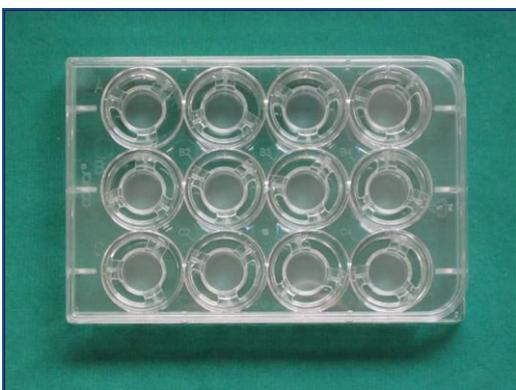
**Abb. 2.3:** 12-Well-Platte mit 12 Transwell®-Membraneinsätzen (Durchmesser der Einsätze: 12 mm, Porengröße: 0,4  $\mu\text{m}$ ) zur Kultivierung der Nasenschleimhaut (Corning Incorporated-Life Sciences, NY, NY, USA).
