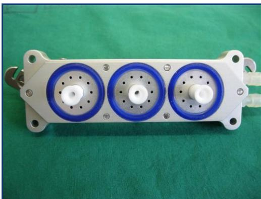
**Abb. 2.6 b:** Innenansicht des Deckels der in Abb. 2.6 a abgebildeten Vitrocell®-Kammer (Vitrocell® Systems, Waldkirch) mit Gasein- und auslassöffnungen für die 3 voneinander abgetrennten Räume.
