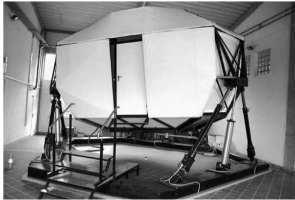
Abbildung 1.4.: Bewegungssystem. Die Kabine ist leicht nach links gekippt, was für den Fahrer die Beschleunigungen beim Durchfahren einer Rechtskurve simuliert.
