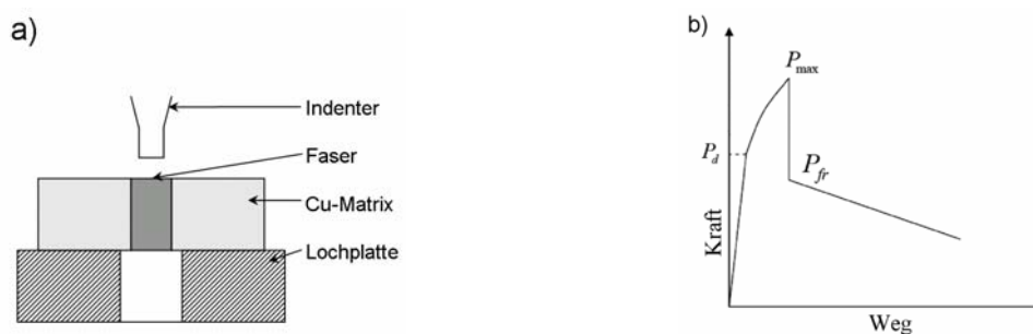
Abb. 4-2: a) schematischer Aufbau Push-Out-Versuch; b) idealer Kraft-Weg-Verlauf Push-Out-Versuch
