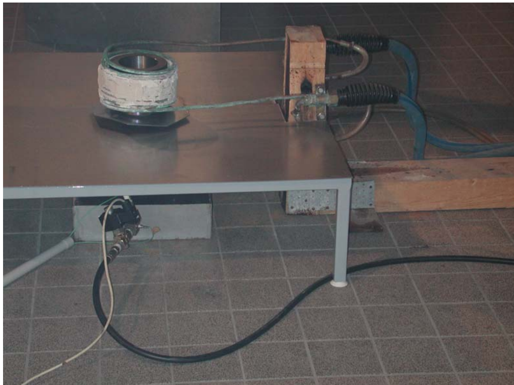
Abb. 2.1: Aufnahme des GFV-Aufbaus. Im oberen Bildbereich sind der Probeniegel und die induktive Heizung zu erkennen. Der untere Bildbereich zeigt die Gasdruckleitung und das Magnetventil, dass der Luftdruckstoß reguliert.
