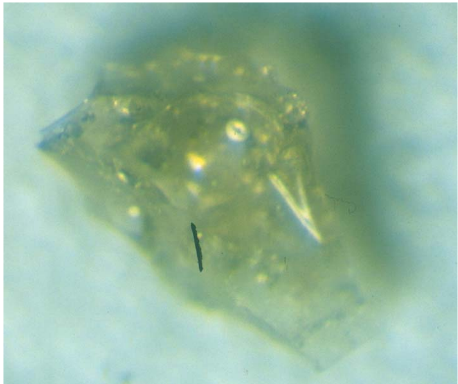
Abb. 2.26: ABM-Aufnahme (Vergrößerung 25X) eines Partikels der Kornklasse 7,1 \cdot 10^{-4} \text{ m} < x < 1,0 \cdot 10^{-3} \text{ m} (AMS). Dabei sind sowohl angeschnittene Blasen an der Partikeloberfläche, als auch etliche eingeschlossenen Blasen im Partikelinneren zu erkennen.
