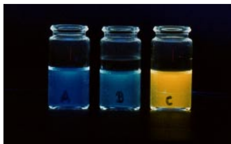
Abbildung 2.7. Fluoreszenz des Oxazolins 7h ( c = 5 \cdot 10^{-5} M, \lambda_{\text{ex}} = 366 nm) in methanolischer Lösung (A), nach Zugabe von Silberkationen (B) und nach Zugabe von 0.5 M HCl (C)
