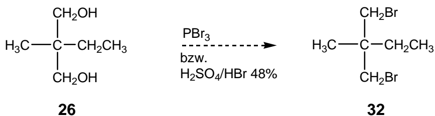
Abb. 35. Synthesepfad zur Herstellung des zweifach alkylierten Dibrompropans 32
