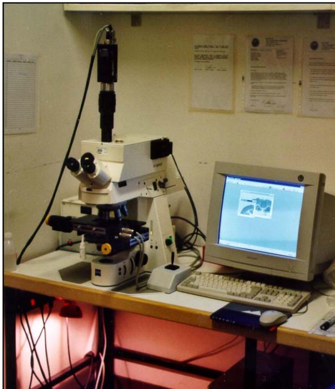
**Abb14.: Histologische Morphometrieinheit mit Mikroskop, CCD Kamera und PC**
