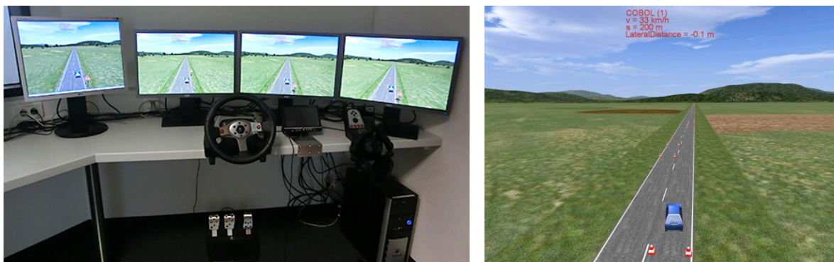
Abbildung 12: Operatorenplatz für die Einzelfahrten im Training. Jedes der vier Pulksfahrzeuge wird auf einem separaten Bildschirm dargestellt (links). Wichtige Informationen werden direkt in den Bildschirm eingeblendet (rechts).
