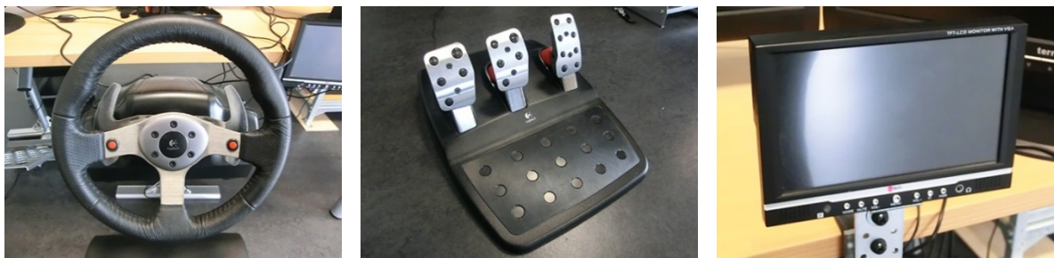
Abbildung 7: Hardware der Pulksimulation: Lenkrad mit Lenkradwippen und Knöpfen zur Blinkerbetätigung (links), Pedalerie (Mitte), LCD-Display (rechts).
