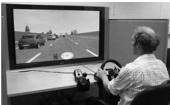
Abbildung 2: Tischsimulation (links, aus Gony, Diels, Reed, Stevens, & Burnett, 2013, S. 3). Fahrsimulator mit Hexapod und Schlitten (rechts, aus Breuer, 2009, S. 58).
