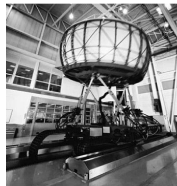
Abbildung 2: Tischsimulation (links, aus Gony, Diels, Reed, Stevens, & Burnett, 2013, S. 3). Fahrsimulator mit Hexapod und Schlitten (rechts, aus Breuer, 2009, S. 58).
