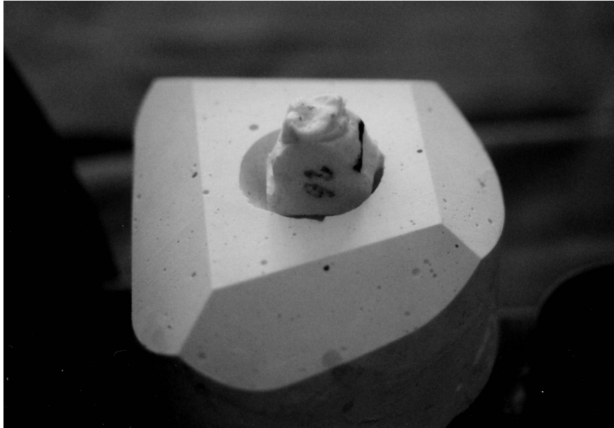
Abbildung 2-9: Einzelner Zahn (hier 26) im Gipshalter. Die Unterkieferzähne wurden mit Silikon befestigt, die Oberkieferzähne mit Modellierkunststoff.
