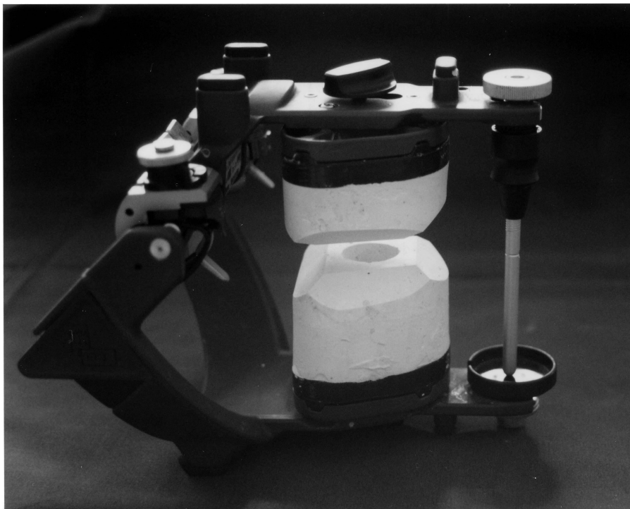
Abbildung 2-10: Artikulator mit eingesetzten Haltern (hier ohne Zähne). In den muldenförmigen Vertiefungen konnten die einzelnen Zähne fixiert werden. Zur Messung wurde der Stützstift angehoben.
