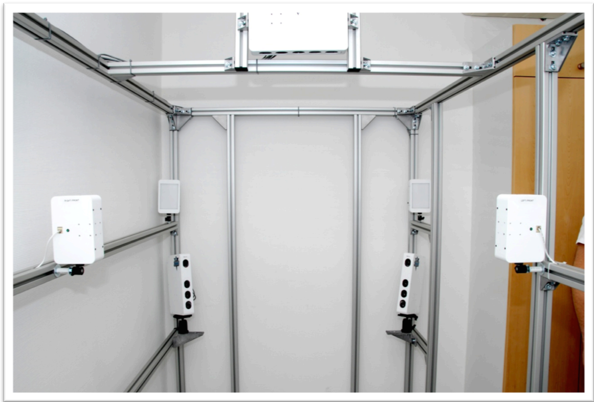
Abbildung 17: Stereophotogrammetrischer Scanner mit sichtbarer Rahmenkonstruktion für die Kameras
