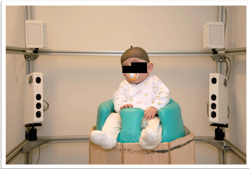
Abbildung 18: Stereophotogrammetrischer Scanner mit einem Patienten zum Zeitpunkt der Aufnahme im speziellem Kindersitz. Nylonmütze zur Verhinderung von Artefakten durch Kopfbehaarung.
