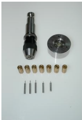
Abbildung 3.7: li.: Durchstoßstempel unterschiedlicher Größe aus Edelstahl und Messinginserts als Widerlager, re.: eingespannt in Universalprüfmaschine [Typ 7074.156, Zwick]
