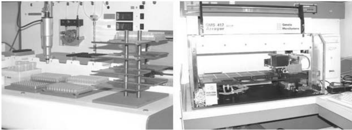
Abb. 7. Pipettierroboter und Microarray-Spotter. Links dargestellt ist ein Ausschnitt des für die Reamplifikationen verwendeten Pipettierautomaten `RoboAmp 4200P` (MWG Biotech AG). Zu erkennen sind u. a. der automatische Deckelöffner (hinten links), die gekühlte Position für Reaktionsgefäße (links), die vier Pipettier-positionen, eine kühlbar (Mitte, z. T. mit Mikrotiterplatten besetzt) und der 96-well Thermocycler (hinten rechts, z. T. verdeckt). Auf der rechten Seite der zum Aufbringen der PCR-Produkte verwendete `GMS 417 Arrayer` (Affymetrix). Hinten rechts der 4-Nadel-Kopf für die Applikation der gelösten PCR-Produkte. Vorne drei Stellplätze für Mikrotiterplatten und dahinter die Positionen für 42 Glasobjektträger.
