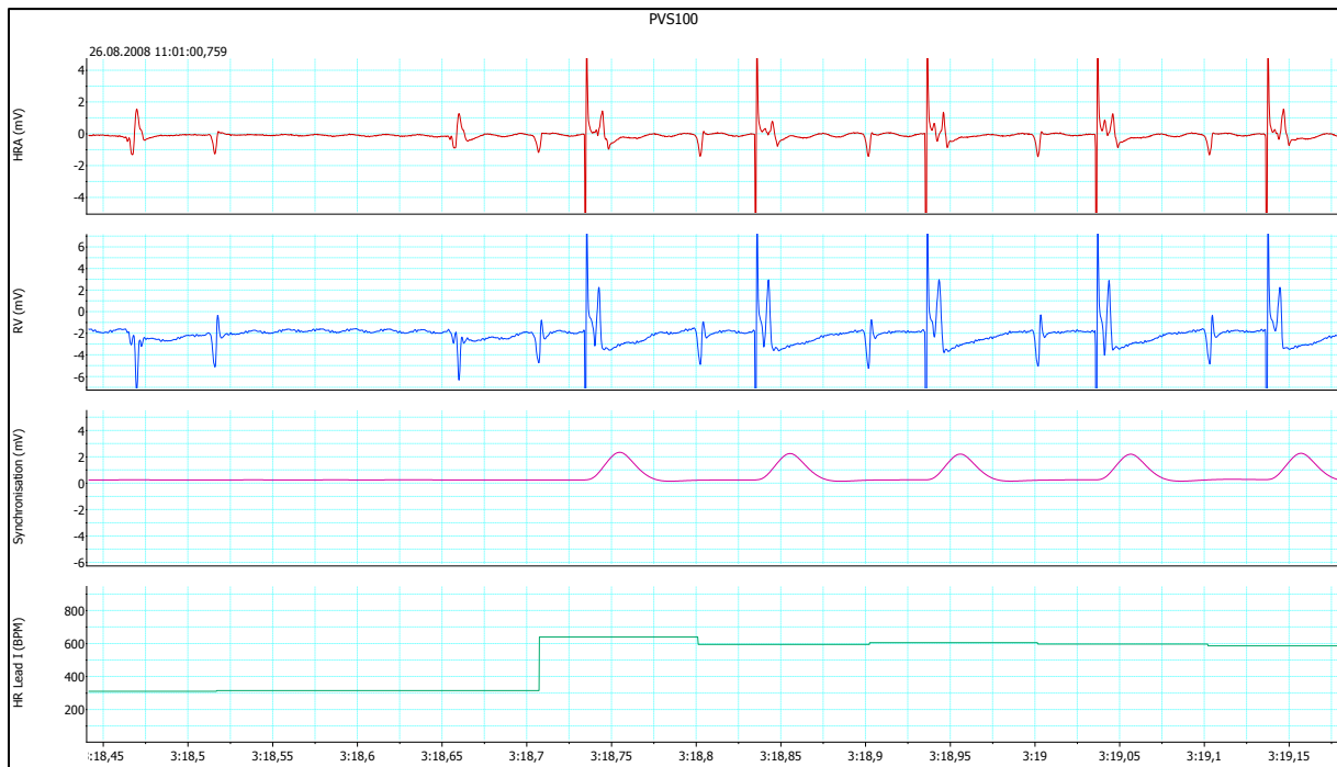
Abbildung 14: Vorhofstimulation: Stimulation des Vorhofs mit einer Zykluslänge von 100 ms Pulsen und intrinsischer AV-Überleitung; 1. Spalte: intrakardiales EKG1 (rot), 2. Spalte: intrakardiales EKG2 (blau), 3. Spalte: Synchronisation/Stimulation (rosa), 4. Spalte: Herzfrequenz/min (HF/bpm = beats per minute) (grün)
