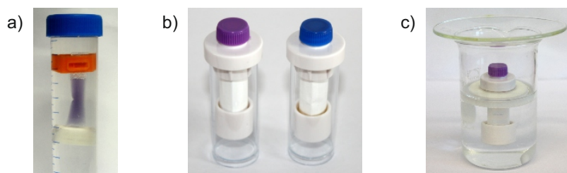
Abb. 3.6: Verwendete Dialyseschläuche; a) geklammerter Dialyseschlauch in einem Falcon-Zentrifugenröhrchen; b) Float-A-Lyzer-Modelle (50 kD bzw. 100 kD) mit Schraubverschluss; c) Float-A-Lyzer-Dialyseschlauch mit Schaumstoffring in einem Becherglas.
