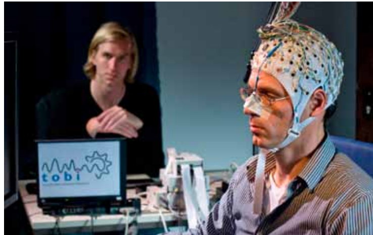
Über Elektroden am Kopf werden die Hirnströme gemessen und in Steuersignale für den Computer umgewandelt.
