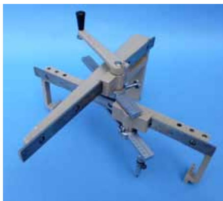
Dieser Ellipsenzirkel ist ein Präzisionsinstrument der Firma C. Riefler, Nesselwang (Foto: Hans-Joachim Vollrath)
