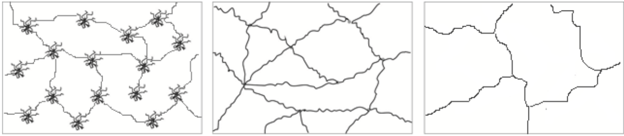
Abbildung 31: schematische Darstellung der organischen Netzwerkbildung in Abhängigkeit des Startergehalts von 3 % (links), 1 % (Mitte) und 0,5 % (rechts) nach einer UV-Härtungszeit von 60 s
