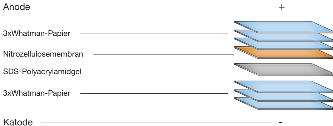
Abbildung 12: Schema des Western-Blot-Aufbau. Auf die Kathode-Platte werden drei puffergetränkte Whatmann-Papier-Stückchen gelegt, darauf das inkubierte SDS-Polyacrylamidgel, oberhalb das Nitrozellulosemembran und anschließend wieder drei Whatmann-Papier-Stückchen. Nach dem Entfernen von Luftblasen wird die Anode-Platte drauf gesetzt. Unter Stromeinwirkung werden die aufgetrennten Proteinbanden auf die Nitrozellulosemembran transferiert.
