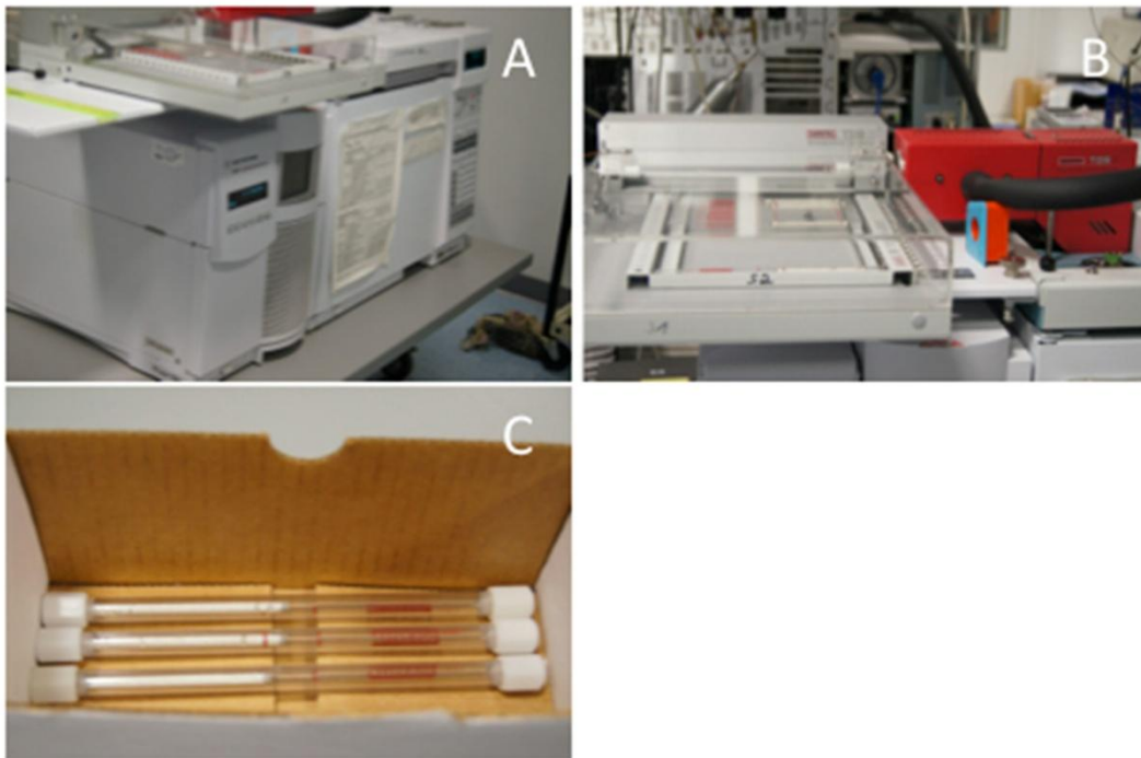
Abb. 11: GC-MS Gerät. A) GC-MS Gerät B) Ansicht des geschlossenen Autosamplers C) Tenax absorbierende Röhrchen
