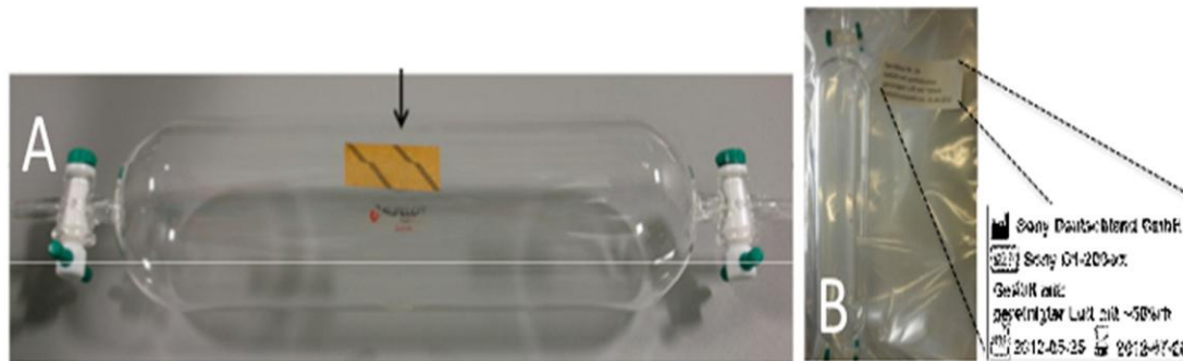
Abb. 8: Gasmaus mit Temperatur-Indikator (Produkt-Nr. SEMA4343) (A) und versiegelte und etikettierte Gasmaus (B).
