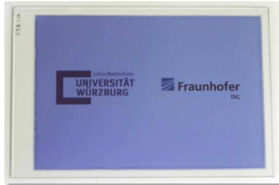
**Abb. 5-24.** Foto einer ORMOCER® IV-c/Fe-MEPE-Schicht (3:1) auf FTO-Glas (20 x 30 cm<sup>2</sup>), hergestellt mittels Tauchbeschichtung bei einer Ziehgeschwindigkeit von 15 mm·min<sup>-1</sup>.
