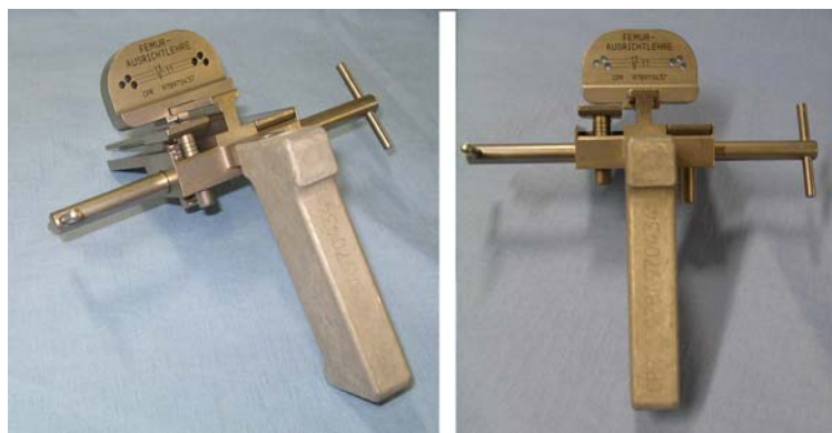
Abbildung 12: Bandspanner mit aufgesetzter Femur-Ausrichtlehre (eigene Aufnahme)
