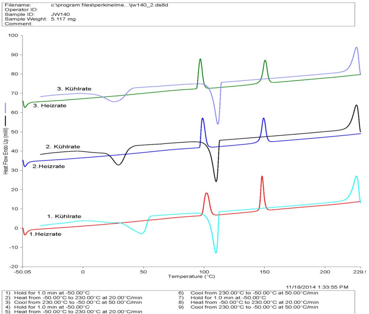
Abb. 38: DSC-Diagramm von P3332OH-Bromid
