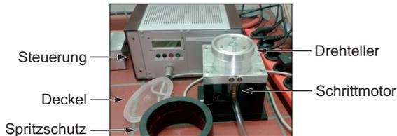
**Abbildung 3.4:** Die Komponenten des Rotationsbeschichters.
