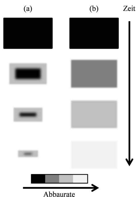
Abb. 3.4: Schematische Darstellung von (a) Oberflächenabbau und (b) Massenabtragung. Wiedergabe nach Lit. [131] mit Genehmigung von Elsevier.
