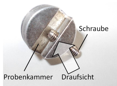
Abbildung 3.3: Probenhalter für das Rasterelektronenmikroskop zur uniaxialen mechanischen Deformation der Proben mit angedeuteter Draufsicht.
